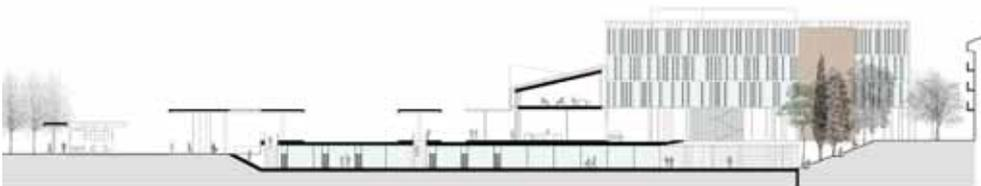
Railway underpass: cross section / sottopasso ferroviario: sezione
